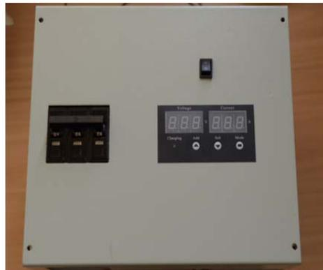
主要实现对蓄电池的充电过程自动控制以及为逆变器提供电压恒定的直流电源和过流保护。
